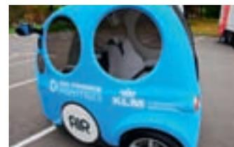
Véhicule à air comprimé
